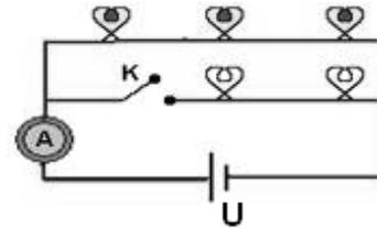
Quando a chave K está aberta, o amperímetro indica uma intensidade de corrente elétrica  $i$ . Se fecharmos a chave K, o amperímetro indicará uma intensidade de corrente elétrica a)  $0,4 i$  b)  $0,6 i$  c)  $1,2 i$  d)  $2,5 i$  e)  $5,0 i$
