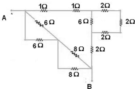
14) Na associação abaixo, a ddp entre os pontos A e B é de 60 volts, determine a corrente elétrica total do circuito.
