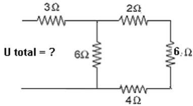
11) Entre os pontos X e Y da figura abaixo, existe uma tensão elétrica de 48volts. Determine a potência elétrica total dissipada por esse circuito.
