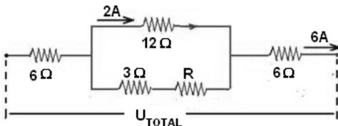
Nessas condições, determine o valor a resistência do resistor R e a tensão total.
