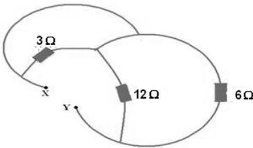
12) Considere o circuito representado no esquema abaixo, onde cada resistência vale  $10\Omega$ . Determine a potência elétrica total sabendo – se que entre os pontos X e Y tem 60 volts.
