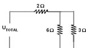
A corrente elétrica que passa no resistor de  $2\Omega$  é de  $9A$ , determine a potência dissipada pelo resistor de  $6\Omega$ , bem como a tensão total do ccto.
